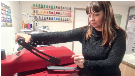
Une presse à chaud pour le flocage
